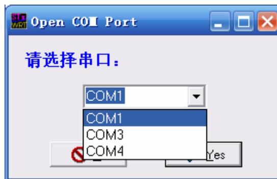
3. 选择数字最大的一个 COM 口（COM4），并按
